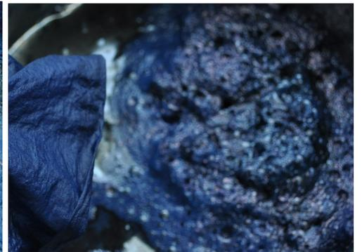
2012年に製造した琉球藍とそれを発酵建した液の微生物の分析、沈殿槽の計測を行い、2013年度の製藍時のpHを決め、水量計算して石灰量を決め、測定を行なった。
