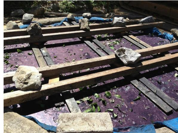
▽浸け込み液中は青緑色、酸化作業まであと3~4時間    ▽50時間経過、発酵が進みpH6.0まで下がる
