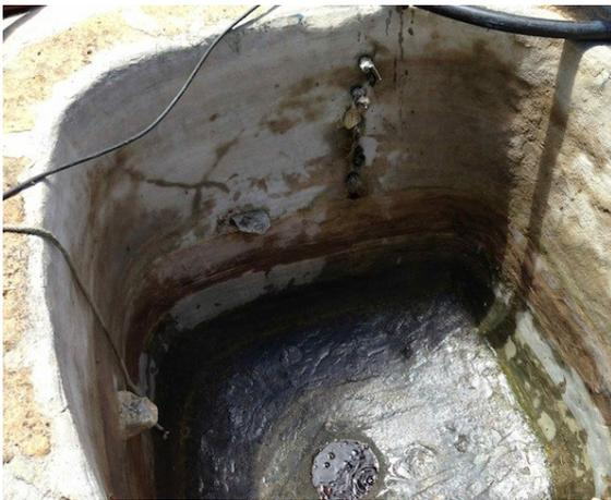
▽沈澱藍が見えたら少し液を戻し攪拌、一気にポンプで貯蔵槽に移す
