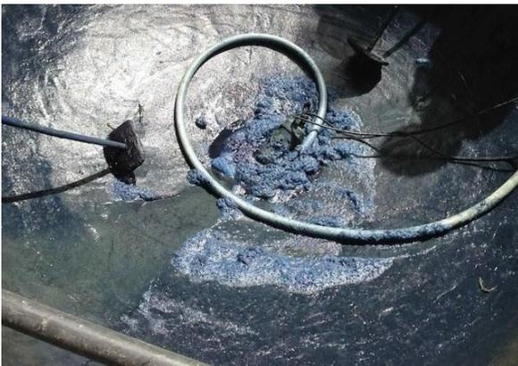
▽貯蔵槽でさらに沈澱させ、上澄みを捨てる
