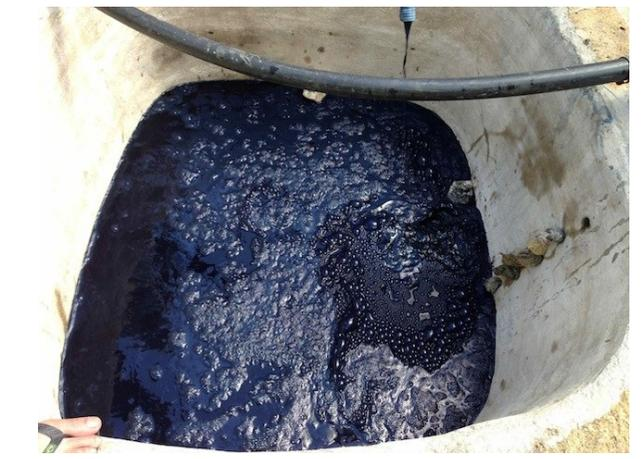
▽さらに沈殿槽の底に残った沈澱藍を取り、貯蔵槽に移す
